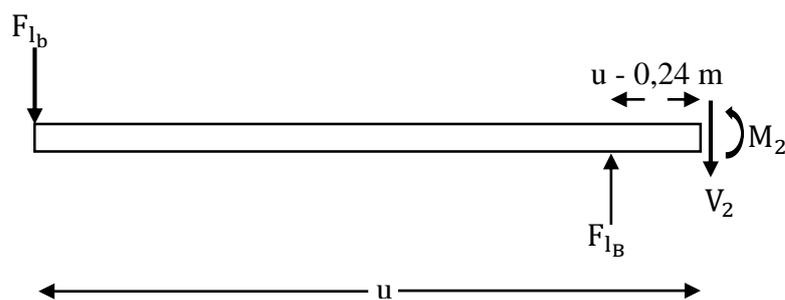
Gambar 4.10. Gaya aksi – reaksi pada batang atas potongan 2.
