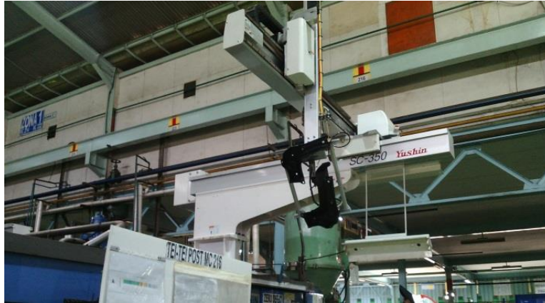
Gambar 4.5 Proses Pengambilan Produk Jadi oleh Robot
