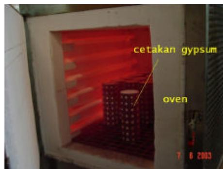
Gambar 3.14 Cetakan Gypsum Siap Dituang Logam Cair
