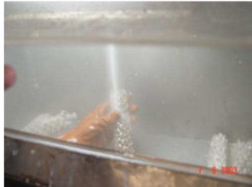
Gambar 3.17 Air Bertekanan Tinggi Menembaki Gypsum Yang Melekat Pada Coran
