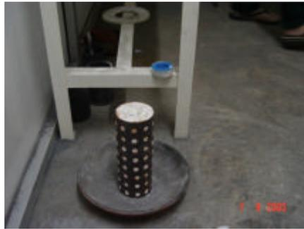
Gambar 3.15 Cetakan Gypsum Yang Telah Terisi
