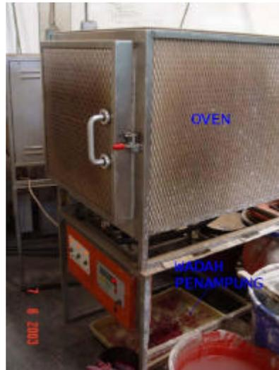
Gambar 3.10 Oven Cetakan Gypsum
