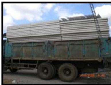
Gambar 4.1. Transportasi Panel – Panel Pracetak M-System
