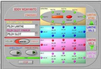
Controller untuk menggerakkan semua *hardware* secara otomatis/manual pada *plant* adalah PLC OMRON CPM1. Komunikasi antara PLC dengan PC menggunakan *Host Link Protocol Communication* pada *Serial Port RS-232*.
