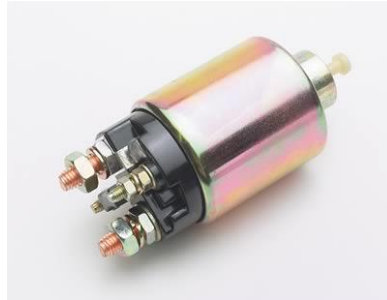
Gambar 2.13. Solenoid pada dinamo starter
