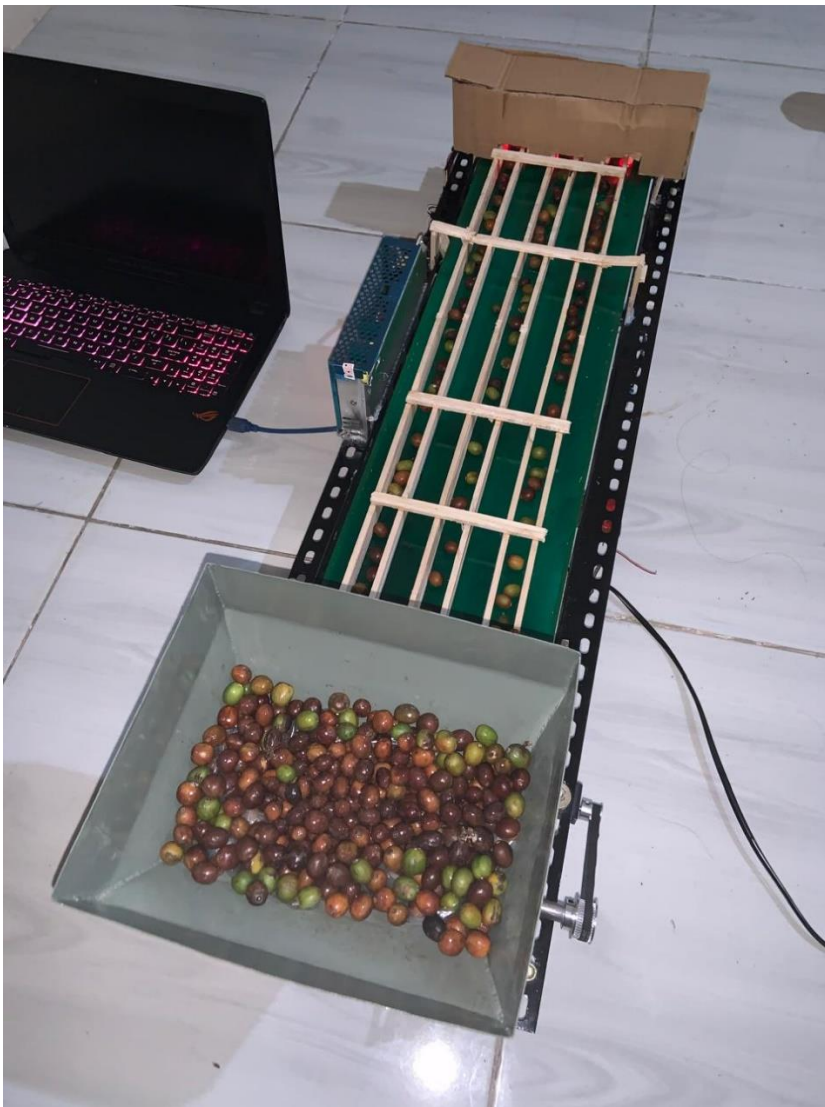
Gambar4. 15 Proses penyortiran buah kopi Sumber: Olahan Peneliti
