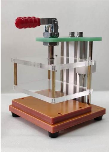
Gambar 2.3 Salah Satu Bentuk *Jig* PCB
