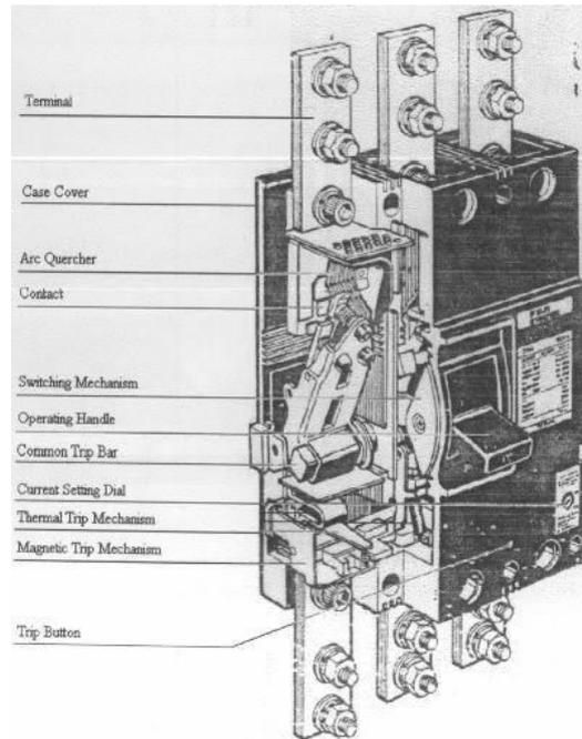
Gambar 2. 11 Konstruksi MCCB
