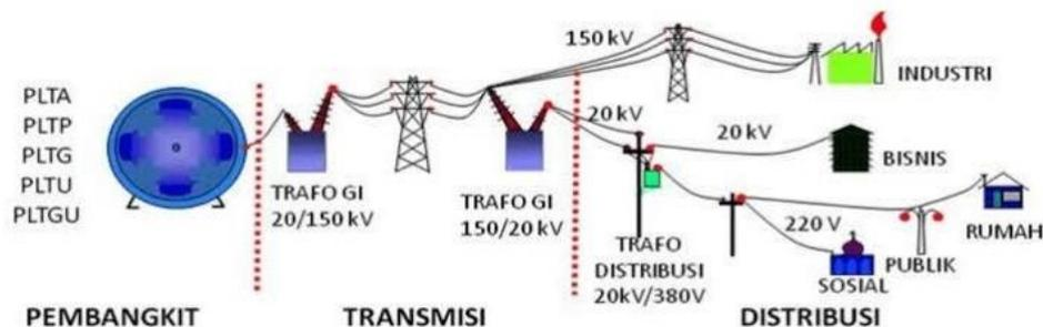
Gambar 2. 1 Diagram Satu Garis Sistem Tenaga Listrik
