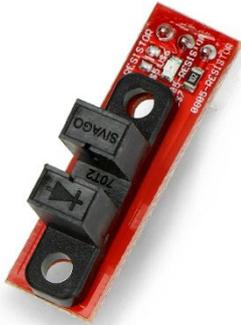
Gambar 2. 9. Sensor Endstop pada 3D Printer.
