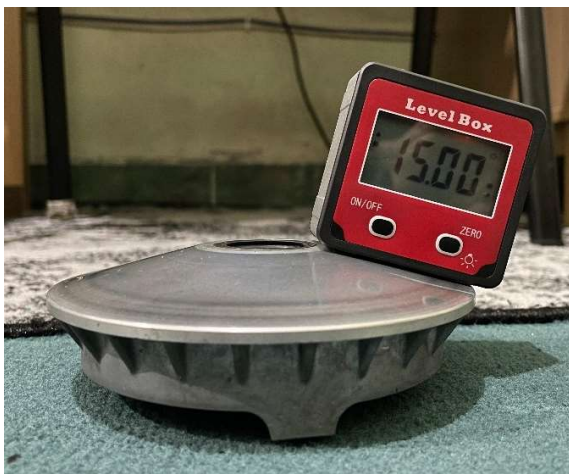
Gambar 2.6 Sudut kemiringan pulley gerak primer 15^\circ
