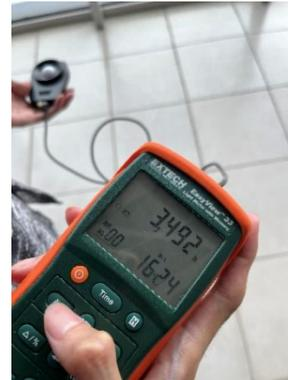
Gambar 3.12 Proses pengukuran intensitas lux pada pencahayaan alami
