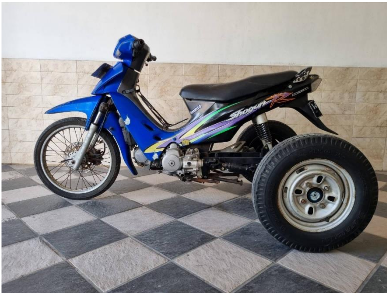
Gambar 4. 3 hasil pembuatan sepeda motor roda tiga
