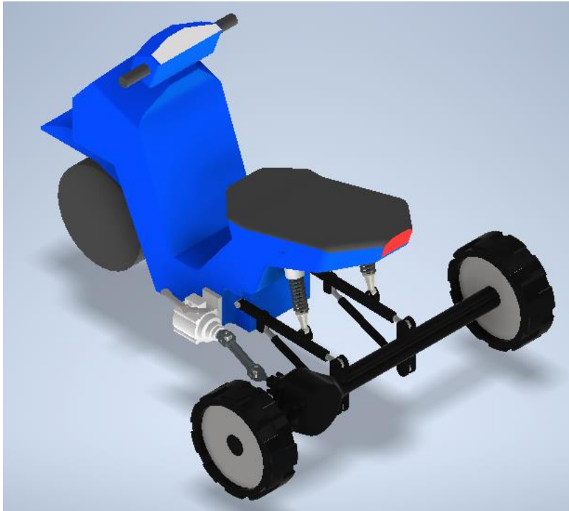
Gambar 4. 2 konsep desain sepeda motor roda tiga
