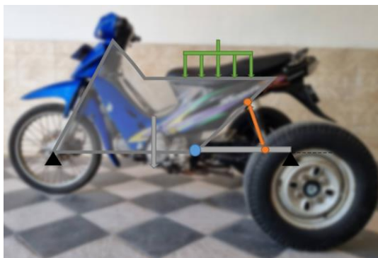
Gambar 4. 14 Sepeda Motor dan Free Body Diagram
