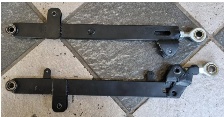
Gambar 4. 7 hasil pembuatan swing arm
