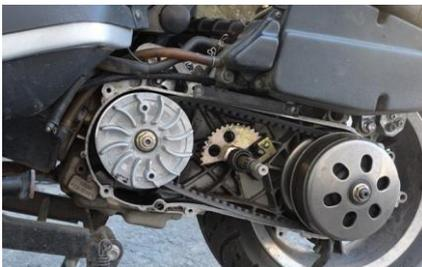
Gambar 2.9 Transmisi Otomatis CVT Sepeda Motor
