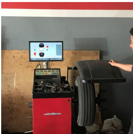
Gambar 4.17 Proses balancing ban menggunakan mesin balancing untuk menyeimbangkan roda kendaraan.
