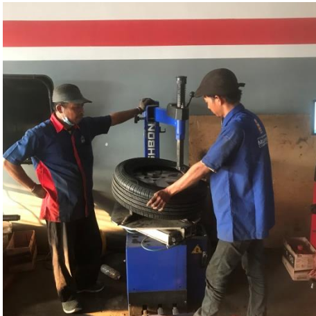
Gambar 4.16 Penggantian ban menggunakan mesin Tire Changer
