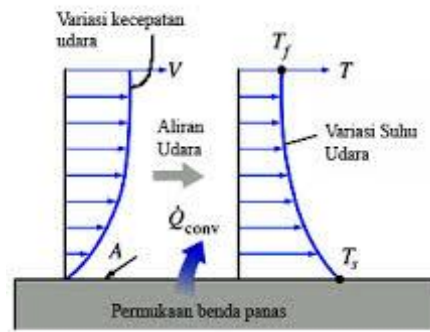
Gambar 2. 4 Perpindahan Kalor secara konveksi
