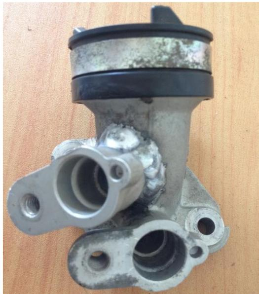
Gambar 3.16. *Intake Manifold* Modifikasi.
