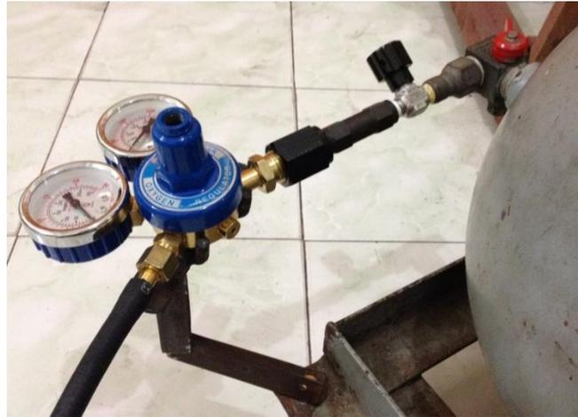
Gambar 3.9. Susunan *Valve* dari Tabung Menuju Regulator.
