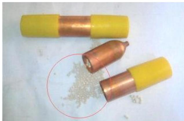
Gambar 3.12. Serbuk *Molecular Sieve* yang Ditunjukkan pada Lingkaran Merah dari Hasil Pembelahan *Filter Dryer Gas*.
