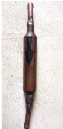
Gambar 3.11. *Filter Dryer Gas*.
