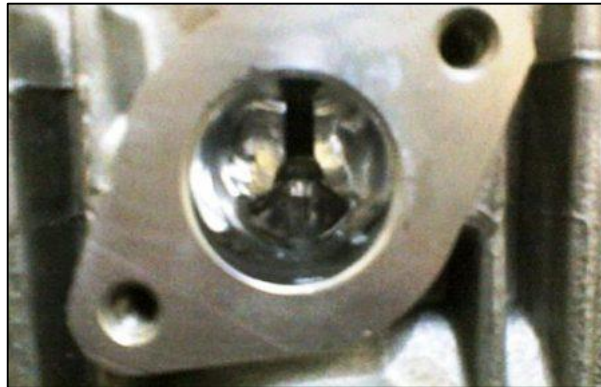
Gambar 2.3 Intake Porting pada Jupiter Z
