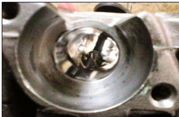
Gambar 2.4 Exhaust porting pada Jupiter z
