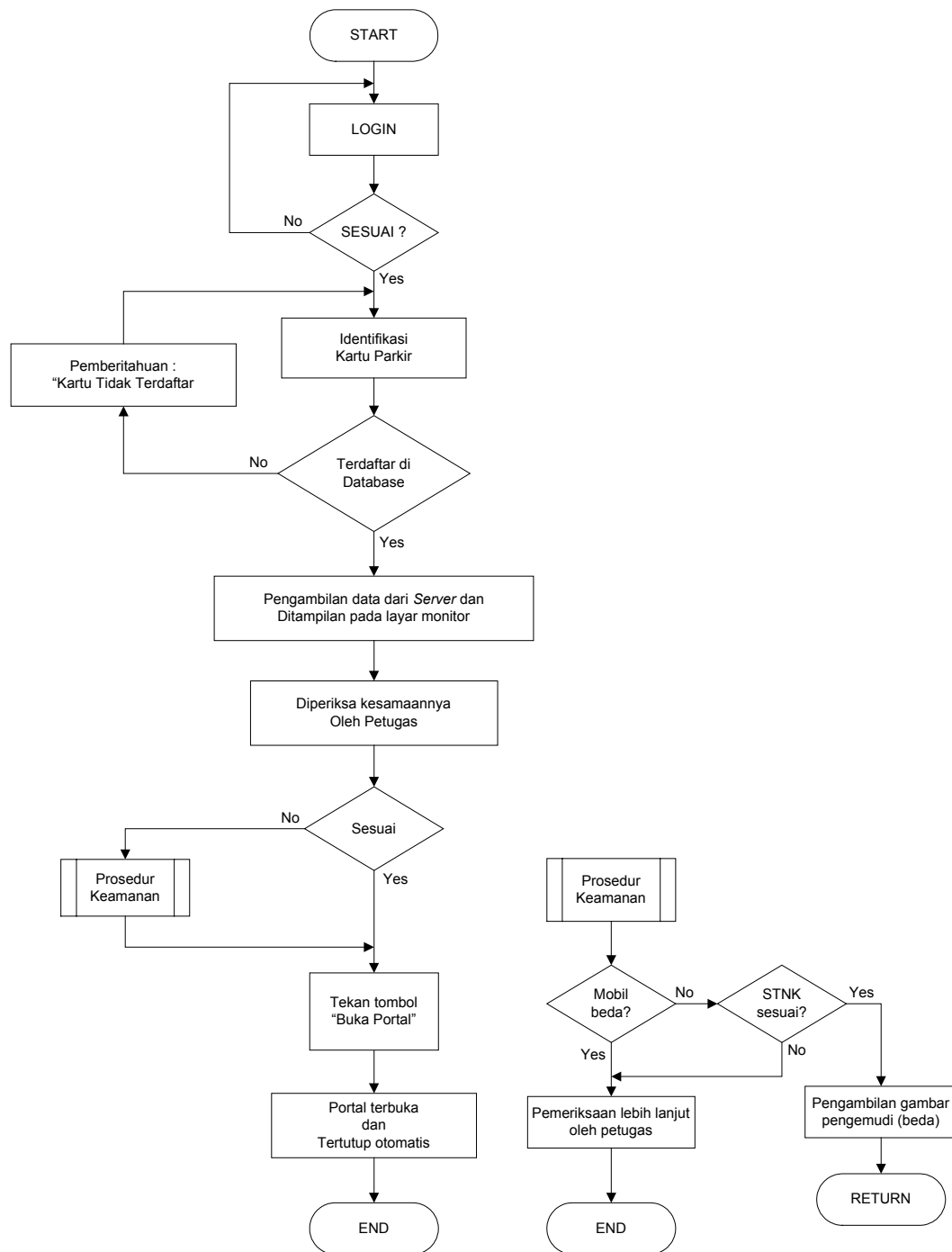
Gambar 3.29. Diagram Alir Proses Loker Pintu Keluar
