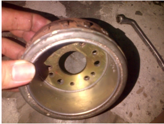
Gambar 4.3 Magnet setelah dimodifikasi pick-up nya
