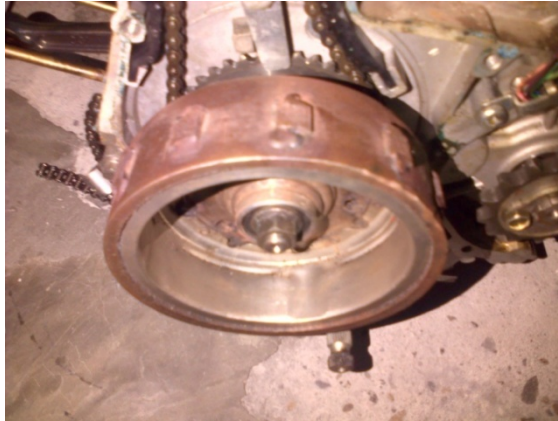
Gambar 4.6 Magnet baru yang telah dimodifikasi
