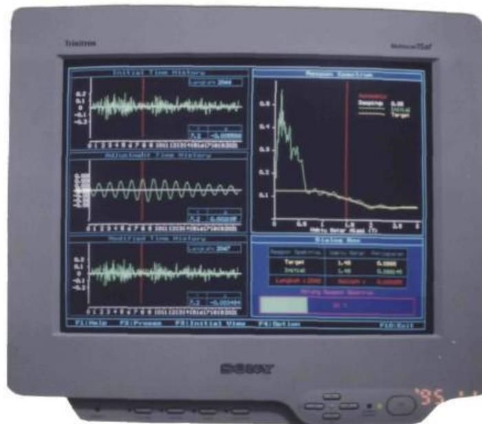
Gambar 4.14. Layar proses penyesuaian respon spektrum pada langkah 2067.
