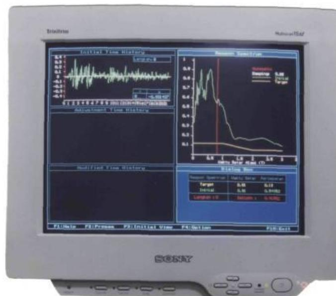
Gambar 4.13. Layar proses penyesuaian respon spektrum pada langkah 0.
